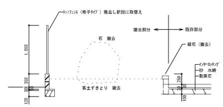
石、灯籠撤去部分 断面詳細図 1:30
