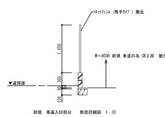
新設 車道入口部分 断面詳細図 1:30
