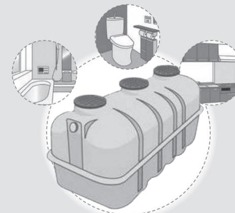
合併処理浄化槽は、台所やトイレなどから出る汚れた水を、それぞれの家庭できれいにする設備です。苅田町では、住宅の新築や改築の際、国の指針に合う「小型合併処理浄化槽」を設置する方に、費用の一部を補助しています。
