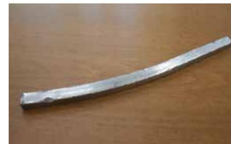
燃やせるゴミに混入していた金属片。処理施設の故障の原因に。
