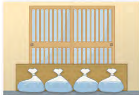
簡易水防工法例② 簡易水のう+止水板
