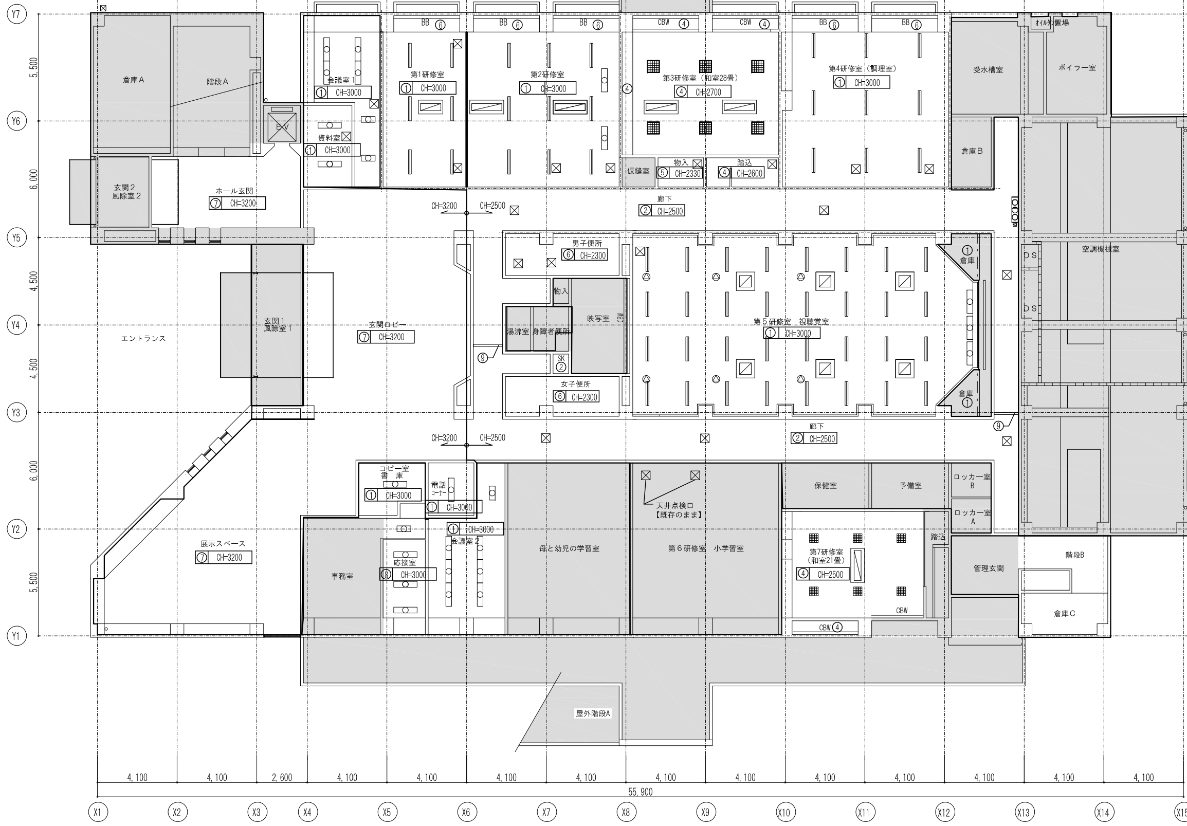
改修後 1階天井伏図 S=1/200
