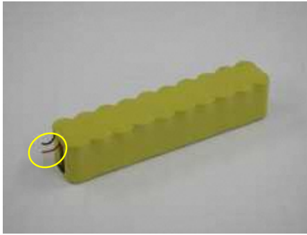
(リード線切断部露出)
