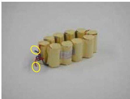
(固定されていない電池パック ／リード線切断部露出)
